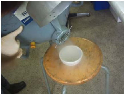
1 pav. Augalo lapai sudėti į grūstuvėlį užpilami skystu azotu.
