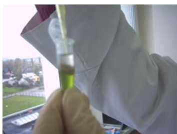
3 pav. Mėginys po pirmo valymo chloroformu. Išsiskiria trys sluoksniai: 1 chloroformas su įvairiomis priemaišomis. 2. ląstelių ir augalo auginių nuolaužos. 3. vandeninis DNR tirpalas.
