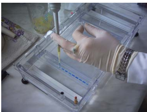
9 pav. Mėginių užnešimas į agarozinį gelį.
