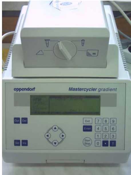
7 pav. Amplifikatorius kuriame yra atliekama PGR reakcija.
