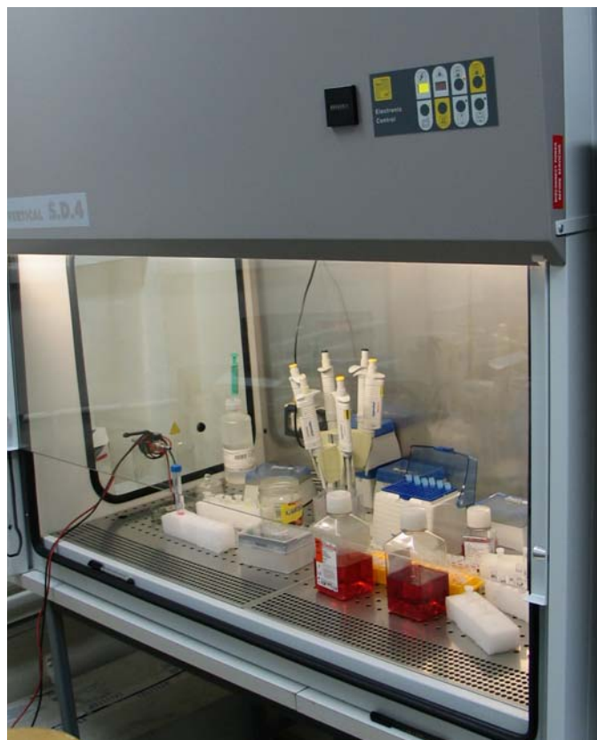
1 pav. Vertikalaus srauto laminaras paruoštas darbui. Viduje matomos visos reikalingos priemonės reikalingos šiam laboratoriniam darbui atlikti.
