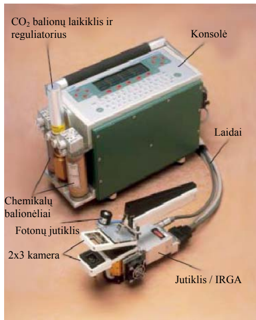
2 pav. Nešiojamas fotosintezės įrenginys LI-6400
